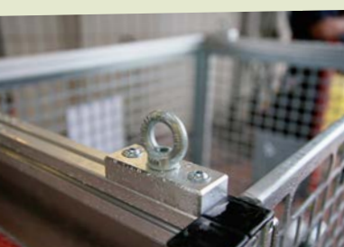
Über solche Lastösen – wie hier am „Munk“ – sind die Rollcontainer kranbar. Fast alle Hersteller bieten sie als Sonderzubehör an.
