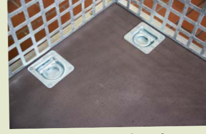
Lob gab es für serienmäßige Befestigungsmöglichkeit für die Ladung. Der Boden des Logiroll ist mit Verzurrpunkten ausgestattet.
