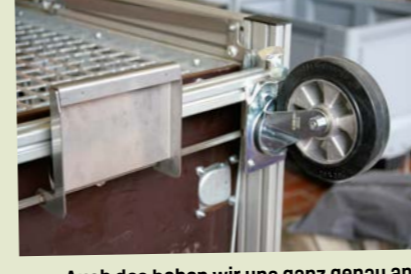
Auch das haben wir uns ganz genau angeguckt: Wie sind die Bremsen konstruiert und wie wirken sie auf die Räder? Ideal sind Trommelbremsen.
