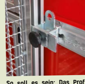
So soll es sein: Das Profil des Rollwagens ist auf das Befestigungssystem im GW-Logistik abgestimmt.
