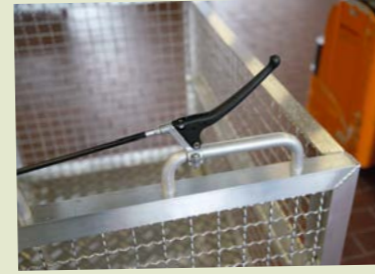
Die Bremse am „Theis“ ist simpel und kann jederzeit ganz einfach repariert werden. Unsere Tester überzeugte die Lösung aber nicht.
