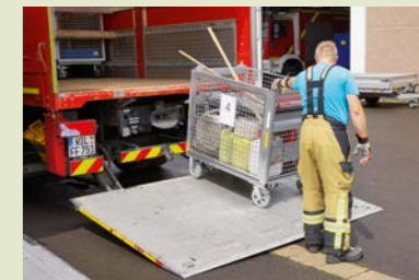
Bremsentest an der schiefen Ebene. Auch ohne angezogene Bremse sollten die Rollcontainer auf der Stelle stehen bleiben.
